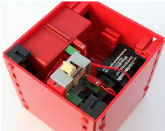
Abb. 7: Verkleidung der Box mit Statik-Platten, Aussparung für den Mini-Motor (rechts)
