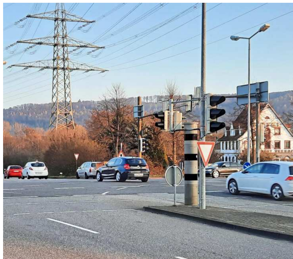
Registriert Rotlicht- und Geschwindigkeitsverstöße: Seit diese stationäre Blitzersäule an der Seehof-Kreuzung steht, gibt es dort weniger Unfälle. Foto: Werner Bentz
