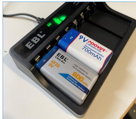
Abbildung 3 Ladeschale mit Ladestandsanzeige für jeden Akku
